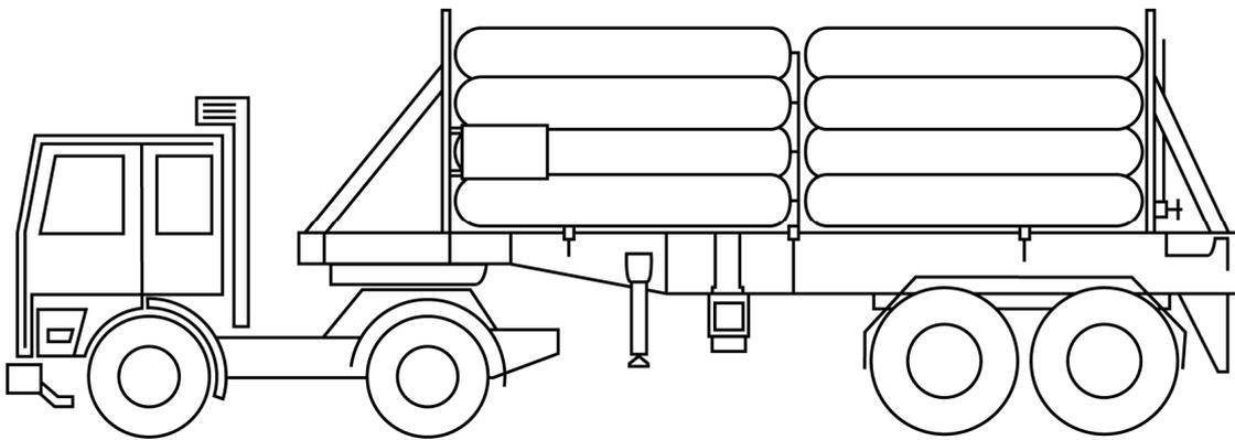
**Figure 5:** Cylinder trailer (tube trailer)
