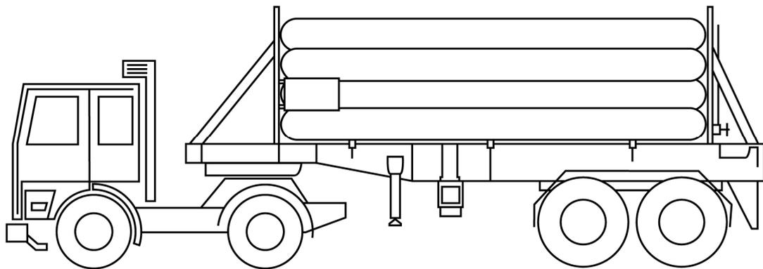
**Figure 3:** Cylinder trailer (tube trailer)
